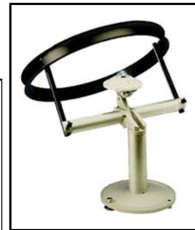
Medição da radiação solar difusa
