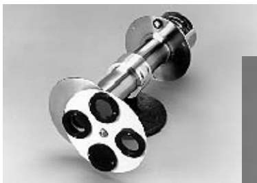
Piroheliômetro + ratreador solar
